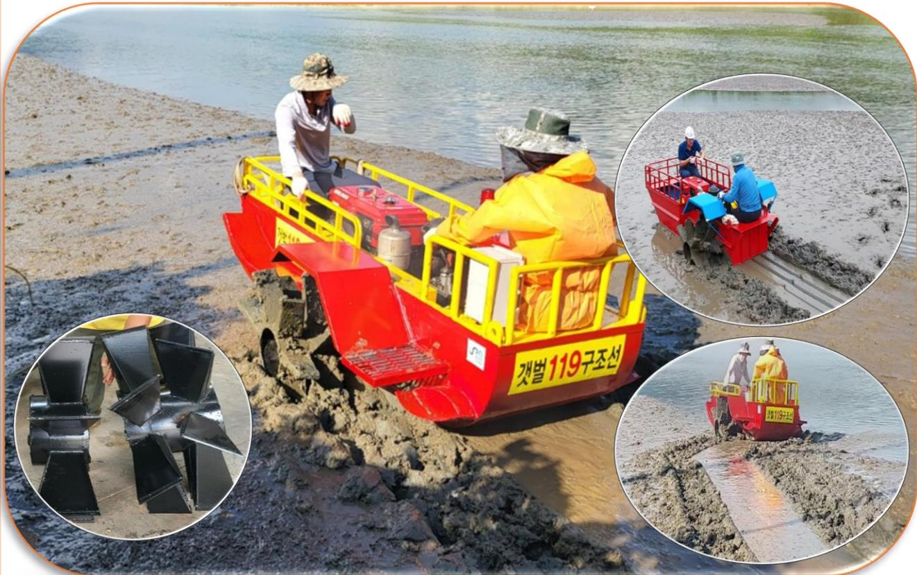
선체 : 3200L \* 1100W (윤폭 최대 2300W) / 엔진 : 디젤엔진 40마력 / 트랜스미션 : f3+r1 & Hi-Low / 견인력 : 500kg (구조 안전보드 견인) / 탑승인원 : 2~3명 / 비상용 전동원치 : 2ton L50m / 자체 부력 : 1000kg / 속력 : 최대 40km/hr
